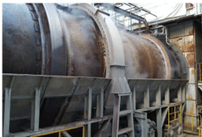
ロータリーキルンでは、燃料を殆ど使用せずに溶融運転を実現しています。
