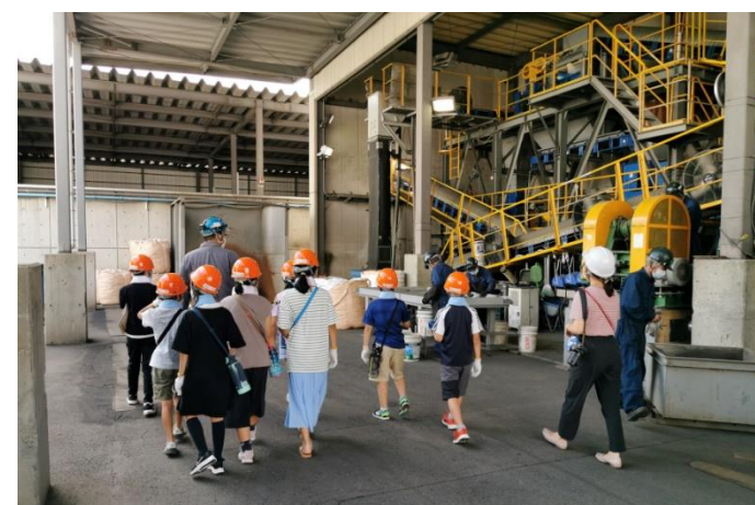
人工砂加工設備では溶融固化物が精製され製品となります。
